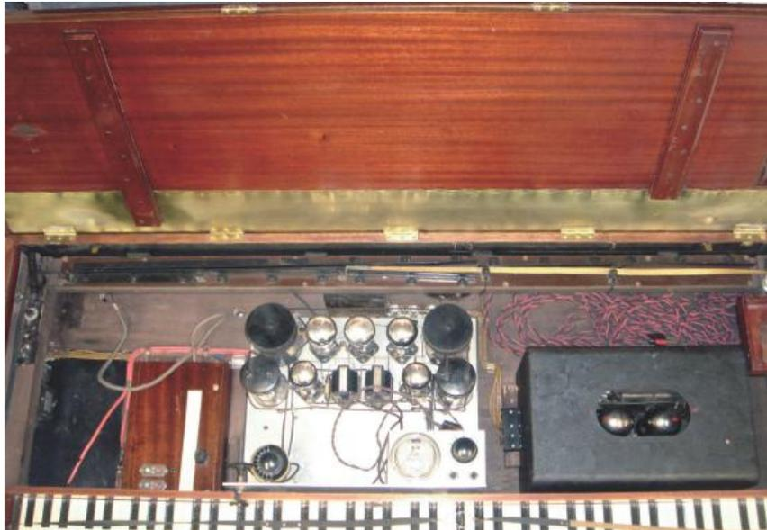
Meuble ouvert : on observe à droite le tiroir rentré, la platine de l'ensemble électronique au centre en bas, et le boîtier d'alimentation à droite. Au milieu on peut apercevoir le condensateur ruban.
